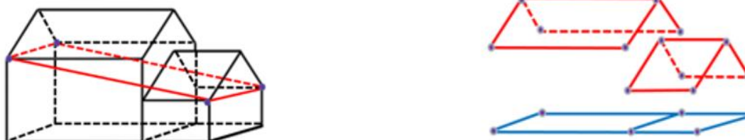
Figur 7.1.2b Två specialfall som inte följer LOD-begreppet enligt CityGML 2.0 men kan hanteras vid utbyte med Svensk geoprocess. Röd linje i vänstra bilden avser 3D-yta för "Lutande takkontur" och utbyts som LOD0 med särskilt värde för attributet höjdläge. Röd linje i den högra bilden avser 3D-tytor som "Fristående LOD2-tak" för utbyte av takkonstruktion i 3D utan väggar.
