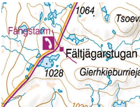
Figur 5.5.3 Exempel på hjälptelefon samt hur den presenteras i Lantmäteriets Fjällkarta (HMK-standardnivå 1), det vill säga i form av en symbol för telefon.
