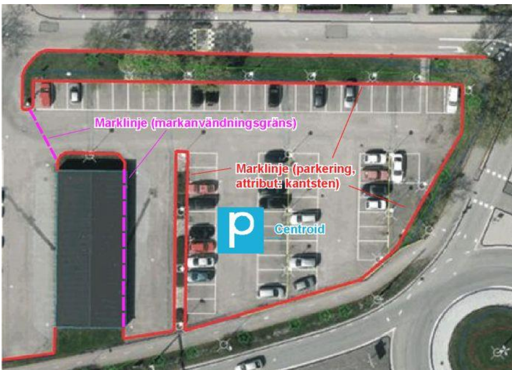
Figur 6.3b Exempel på parkering beskriven med marklinjer kodad som övrig marklinje/markanvändningsgräns och transportlinje/parkering samt centroid kodad markanvändning/parkering
